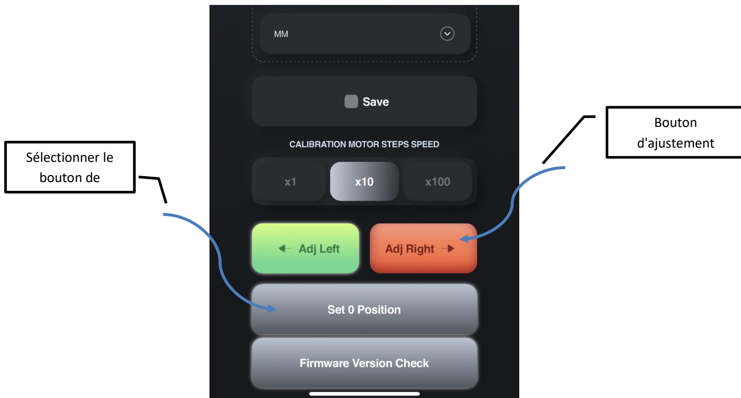
Figure 27 Point zéro : enregistrer le point d'étalonnage en sélectionnant "Set 0 Position"
