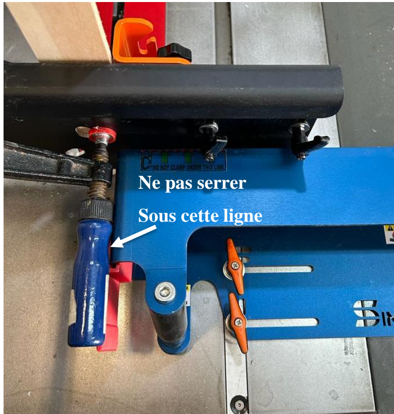
Figure 16 Pince incorrecte, sous le corps du JIG
